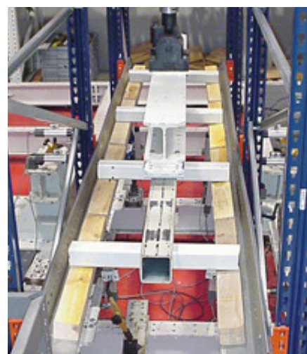
Obrázek 4. Příklad testování nosné lišty u vjezdových paletových regálů
