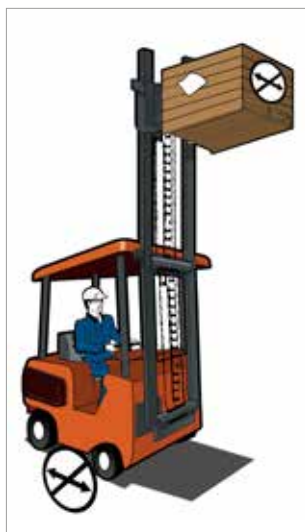
obr. 1. Nejezdit se zdviženým nákladem.
