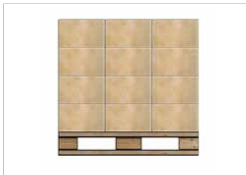
Rozměry skladované jednotky a palety jsou stejné, jako rozměry palety, jednotka a paleta stojí rovně.
